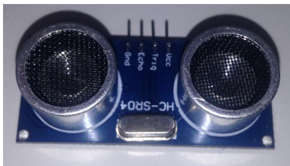
圖四 HC-SR04 超音波測距模組
